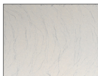
ZBYT MAŁE NANIESIENIE
